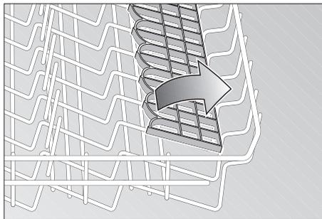
Dlouhé díly, servírovací nebo salátové příbory, vařečky nebo nože mají místo na etažéru, čímž nezabraňují otáčení ostříkovacího ramena. Etažéry můžete podle libosti sklopit nebo odklopit.
